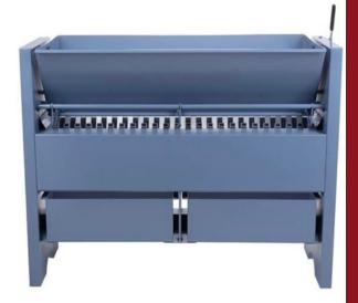
Este cuarteador permite la división de muestras de gran tamaño. Diseñado con una estructura de acero galvanizado para protegerlo de la corrosión.
