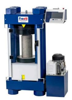
Estructura de cuatro columnas de acero rígido y un asiento esférico que permite la libre alineación en el contacto inicial con la muestra.
